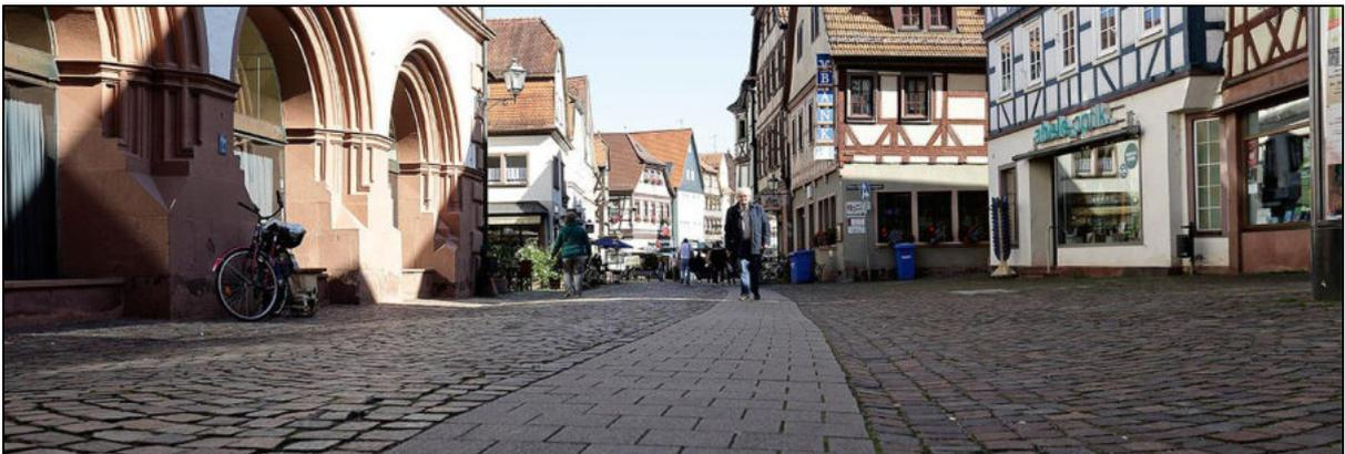
Abb. 53: Beispiel: Kopfsteinpflaster mit abschnittsweiser Verwendung von Belägen mit geringerem Rollwiderstand
