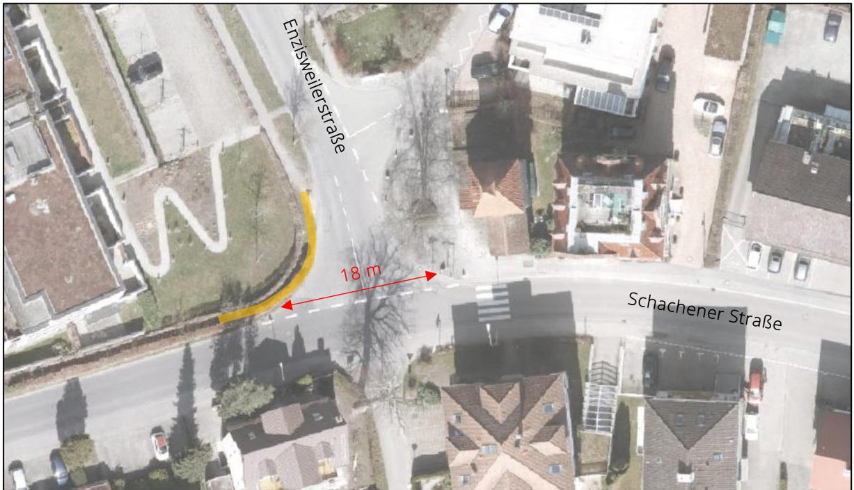
Abb. 71: Weitläufige Kreuzungsplateaus mit langen Querungslängen; fehlendem Gehweg im Kreuzungsbereich (orange)
