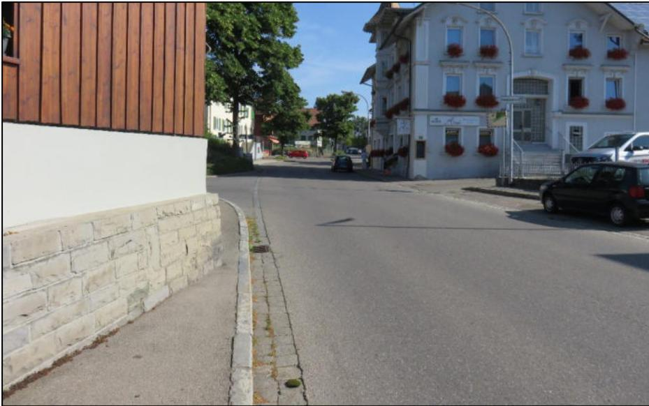
Abb. 31: Engstelle: Fußgänger muss auf Fahrbahn ausweichen – für Rollstuhlfahrer/Rollator ein Hindernis
