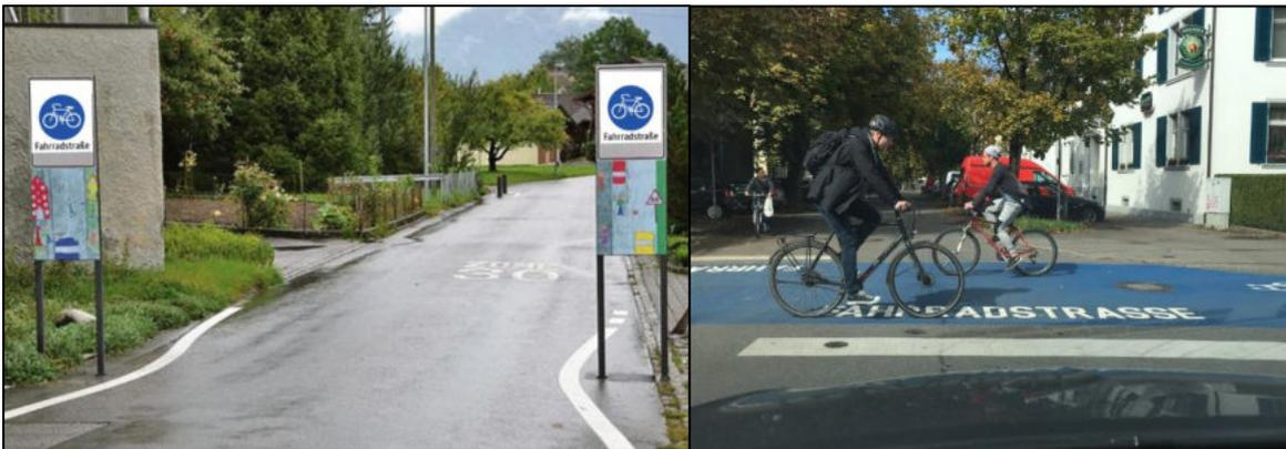
Abb. 64: Torwirkung (links) + stellenweise Einfärbung bei Knotenpunkten in Konstanz (rechts)
